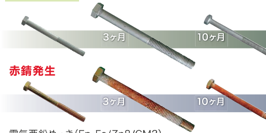
電気亜鉛めっき (Ep-Fe/Zn8/CM2)
