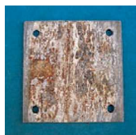
電気亜鉛めっき (Ep-Fe/Zn8/CM2)
